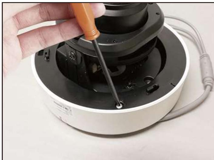
③UNLOCK部分が出来ない場合、ネジをドライバーで外します。
