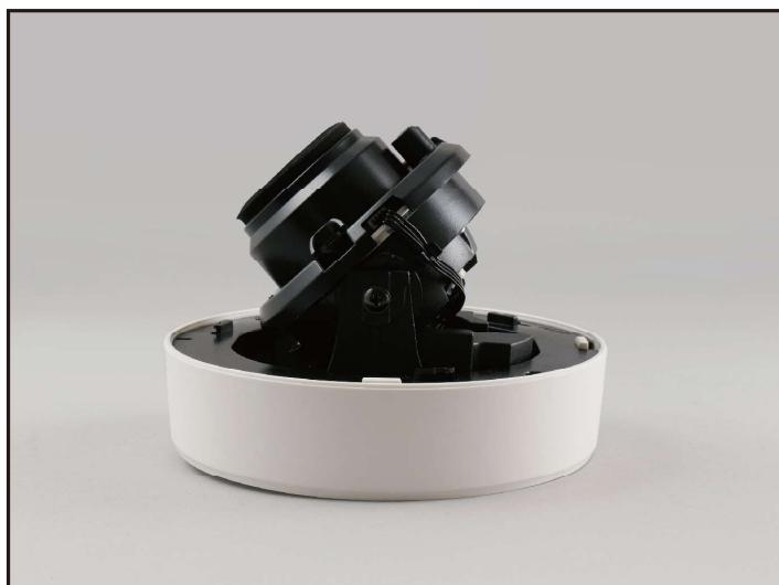
②左図のようにカバーを外し、黒いカバーのUNLOCK部分に棒状のものを指し押し込むと裏面が取り外し可能です。
