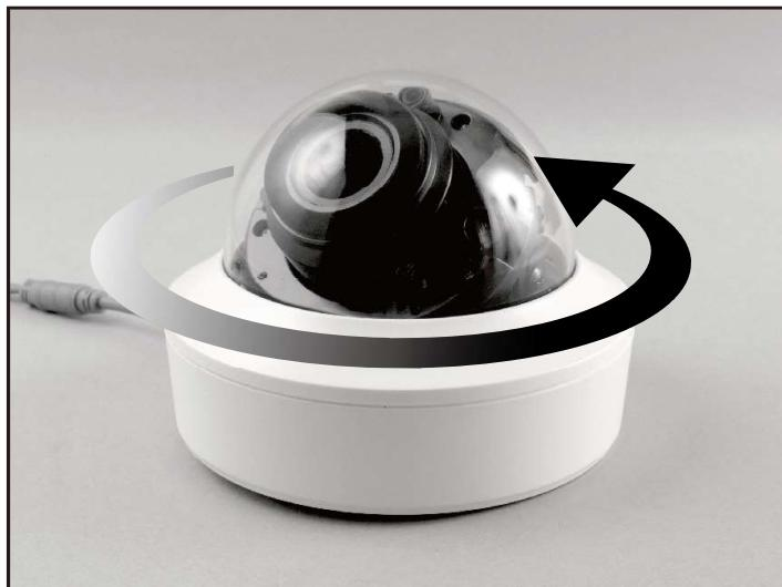
①本体のドームカバーを反時計回りに回します。
