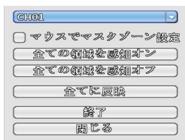
一部撮影しない箇所を設置する場合は、マウスでマスクゾーン設定にチェックを入れ、撮影しないエリアの格子をクリックで選択するか、左端にマウスを合わせ、ドラッグしたまま右端にマウスを移動させてエリアを指定します。
