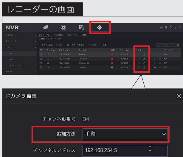
(C) NVR設定が「手動」になっている
