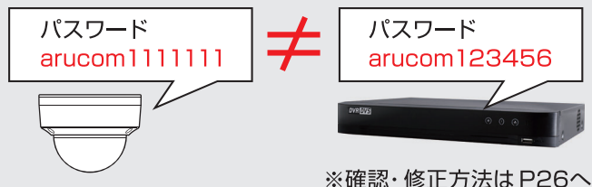
(F) カメラのパスワードと、DVR側のカメラパスワードが違う
