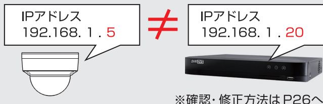
(E) カメラのアドレスと、DVR側のカメラ登録IPが違う
