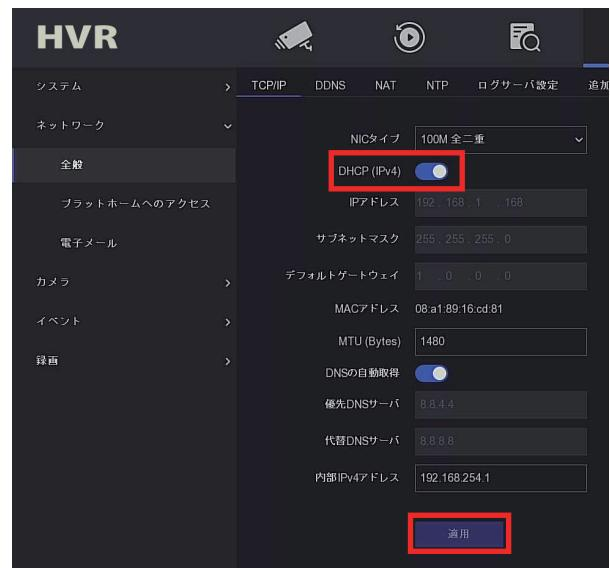
(3) HVRに設定するIPアドレスが決まっている場合、IPアドレス・サブネットマスク等の手動設定を行ってください。また、「内部NIC IPv4アドレス」とは、HVR背面の内蔵PoEポート側のIPアドレスになります。
