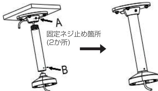
④カメラとケーブルを接続し、カメラを固定し取付完了です。
