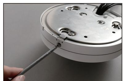
最後に、時計回りに固定ネジを締め付け、カメラを固定します。
