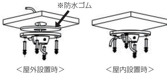
③アダプターへ、カメラ取付プレートを取り付けます。
