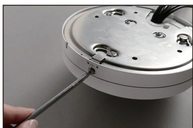
時計回りに固定ネジを締め付け、
