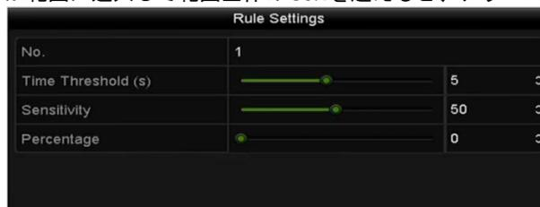
図10.7 侵入横断検知ルールの設定
